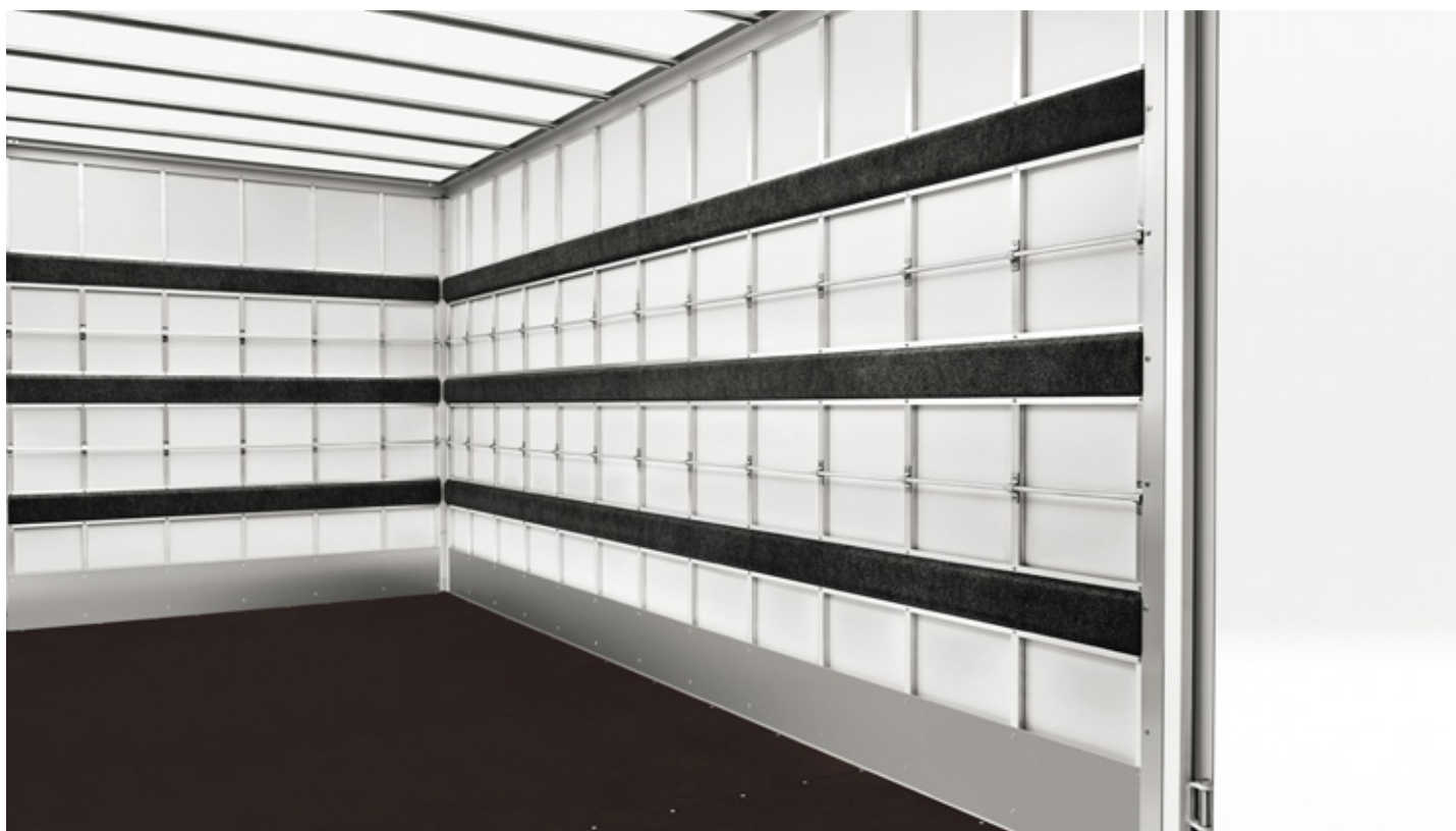
Nakladový prostor s průsvitným stropem a ochrannými bočními lištami.
